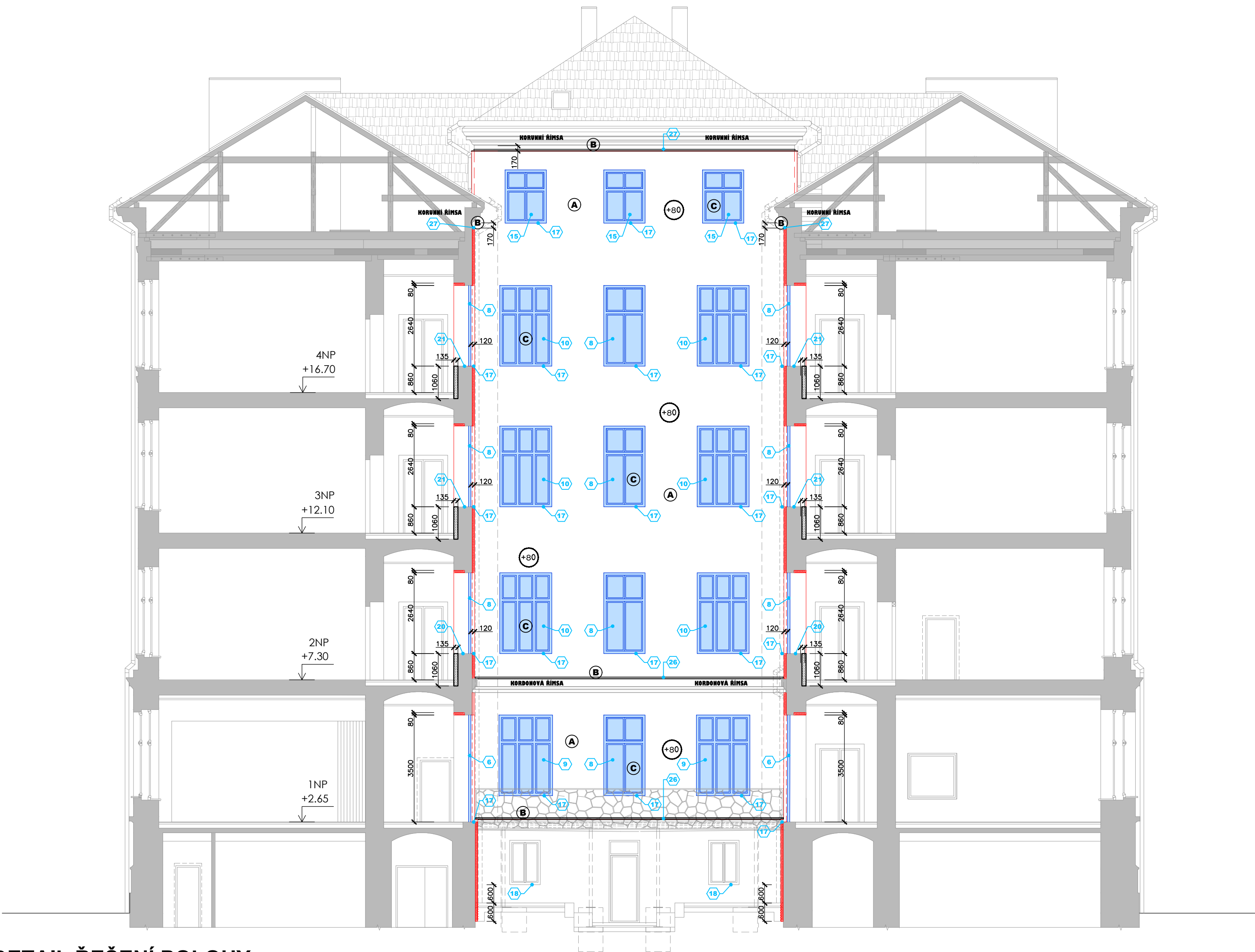
DETAIL ŘEŠENÍ POLOHY UKONČENÍ FASÁDNÍHO ZATEPLENÍ V BLÍZKOSTI KORUNNÍ ŘÍMSY M1:25
